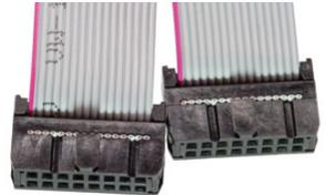
Nur so passt das Kabel später problemlos in die Öffnung auf der Controlleroberseite und in den Wannenstecker auf der Anschlussplatine.
